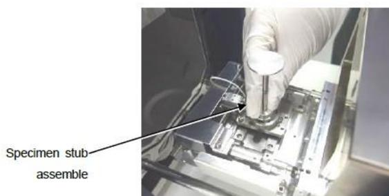
杆连接好后，必须进行高度的测量，使样品的最高处低于高度规的高度限。一般低于 0.5-1.5mm。
