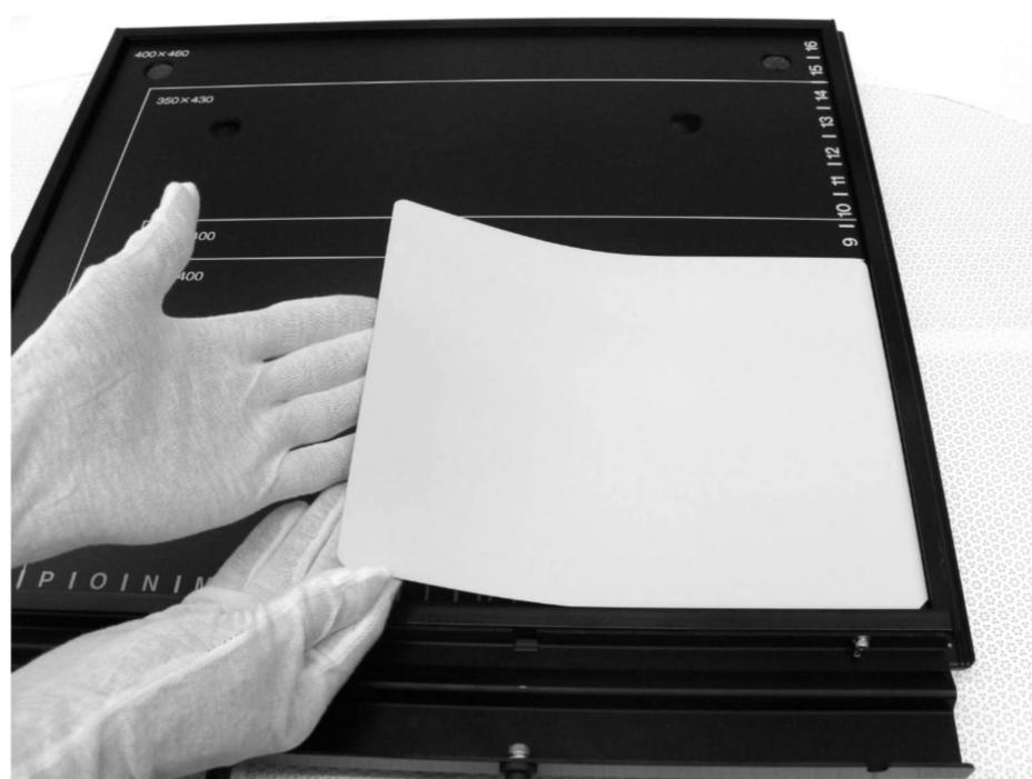
5) 将Phosphor Stage放入Typhoon 5中。盖上仪器盖子。
