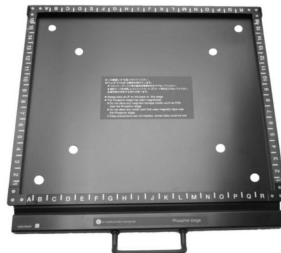
3) 打开磷屏匣子，将吸管吸头贴在磷屏背面，用手指堵住吸管顶部，利用吸管提起磷屏，用手接住磷屏，放开手指，即可取下吸管。
